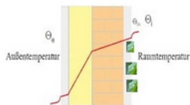
Grenzschicht der Materialoberfläche zur Raumluft
